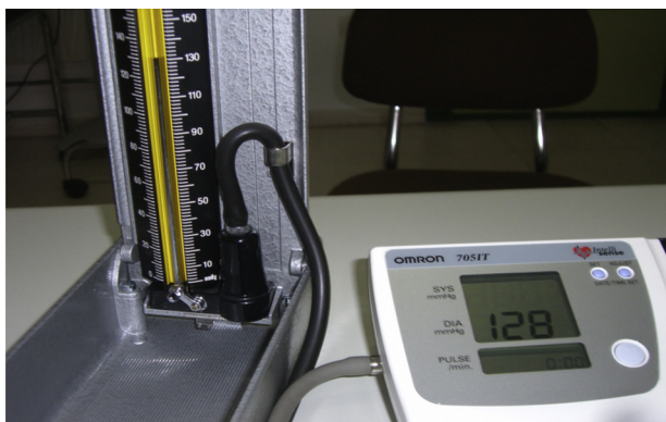
Figura 3 Cifras medias en mercurio y equipo automático conectados en «Y». El de mercurio marca 2 mm de Hg más que el equipo automático.
